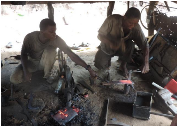
Image n°14: Atelier de forgeron 3. Transformation d'un métal en hache
